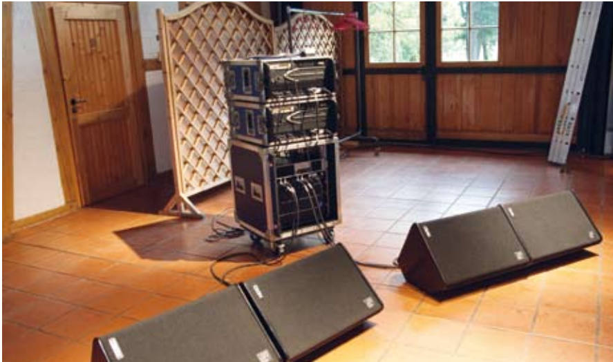
Setup eines typischen Vier-Wege-Monitoring
